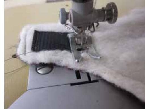
5. Nun werden die Teile zusammengenäht. Der Futterstoff zeigt nach außen. Die Nähte werden nicht versäubert, sondern nur schmal zurückgeschnitten.
